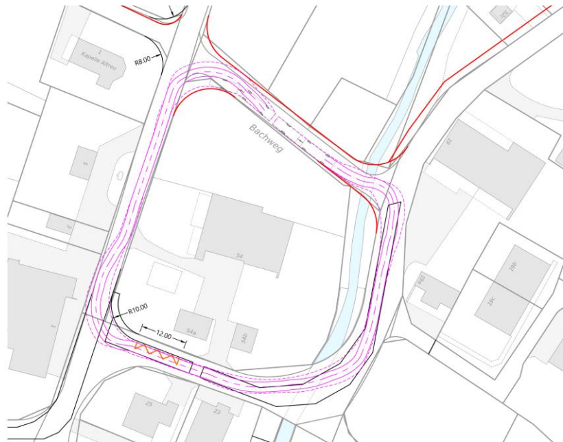
Abbildung 9 Schleppkurven Buslinie, Gelenkbus Nachläufer starr
