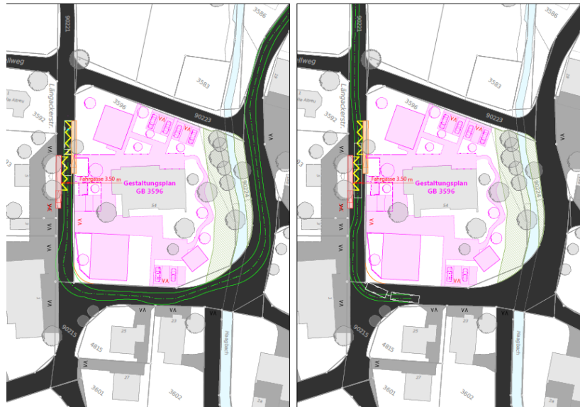
Abbildung 12 Schleppkurven Gelenkbus Nachläufer starr (W+H Ag, 28. August 2026)
